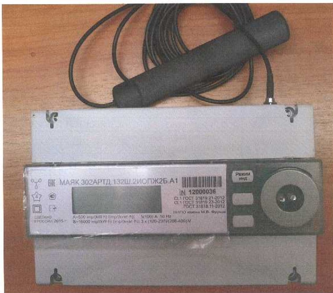
Рисунок 1 – Внешний вид счетчика с закрытыми крышками и внешней антенной
