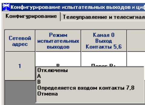
Рисунок 6 - Конфигурирование основного (А) и поверочного (В) режима телеметрии
